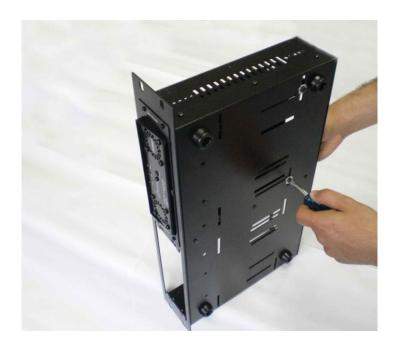
6- Inserir a fonte no gabinete e posicionar conforme permanecerá montada, após efetuar os ajustes desejados, colocar as arruelas e apertar os parafusos de fixação do suporte que os fixavam no gabinete (arruela 5/32 e parafuso m4x6).
