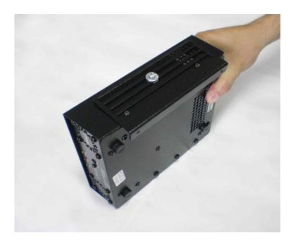
4- Fixar os suportes na fonte com os parafusos M4x8, (não apertar o parafuso para possibilitar ajustes nos próximos passos).
