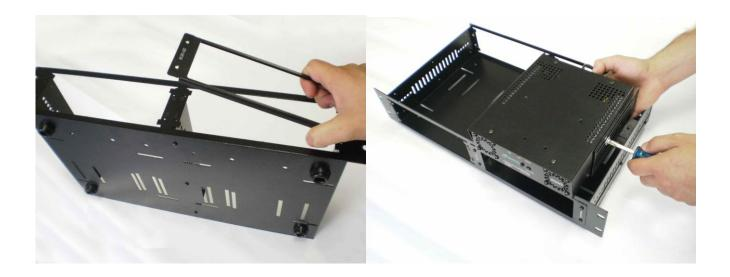
5- Colocar o Painel Frontal de Gab. MTMAX p/ Fonte Montel BP e parafusá-lo no gabinete com parafusos M3x6, posicionar a fonte conforme permanecerá montada, ou seja, com seu painel sobressaindo um pouco do painel do gabinete e com os furos do suporte coincidindo com os furos de fixação do gabinete, após efetuar os ajustes desejados, apertar os parafusos de fixação do suporte.
