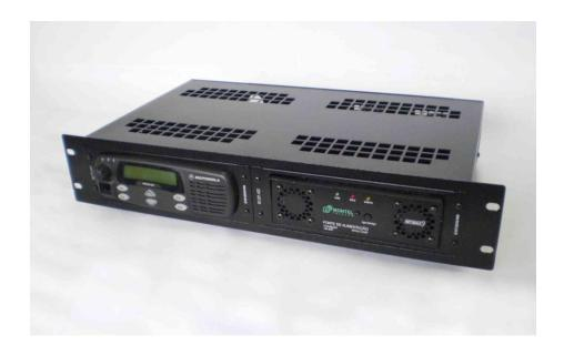
10- Se a montagem for utilizar vários gabinetes e for necessário mais quantidades de rádios, duplexador e de controladora de repetição, montar nas unidades de rack restantes do mesmo modo como já explicado, se alguma unidade não for utilizada, poderá ser fechada com painel de gab. MTMAX p/ fechamento ("painel cego").
