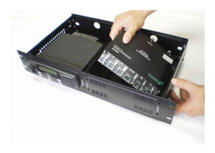
12- Coloque os paineis frontal e traseiro com os 8 parafusos M3x6, em seguida coloque o duplexador na caixa.
